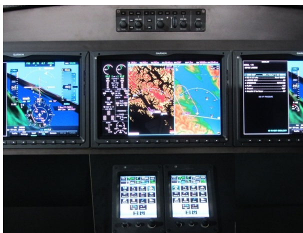
Garmin G3000 no HondaJet – aviônica de fábrica para jatos/turbina, não disponível para C152/PA-28. Foto: FlugKer12 – Wikimedia Commons, licença CC BY-SA 3.0.
