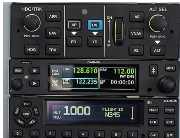
Close-up: controlador GMC 507 do GFC 500, rádio GNC 215 e transponder GTX 345. Foto: Matti Blume – Wikimedia Commons, licença CC BY-SA 4.0.
