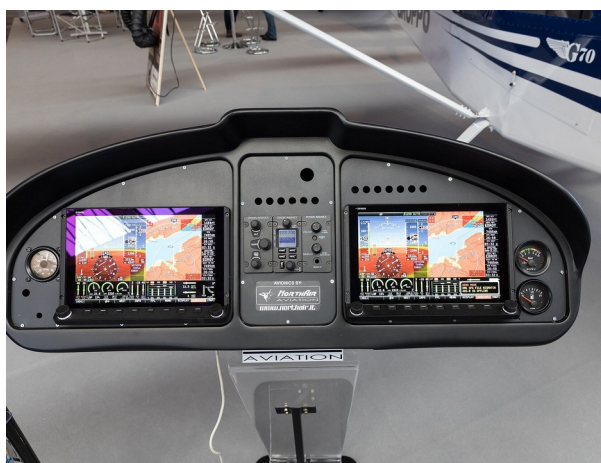
Foto real: aviação Dynon SkyView em painel de exposição. Foto: Matti Blume – Wikimedia Commons, licença CC BY-SA 4.0.
