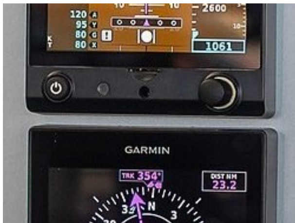
Foto real (close-up): dois Garmin G5 – atitude e HSI – em painel de demonstração. Foto: Matti Blume – Wikimedia Commons, licença CC BY-SA 4.0.
