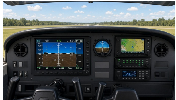
Ilustração / simulação — não é foto real. Cessna 152 DEPOIS: G3X Touch 10,6", G5 de reserva, GPS/COM e transponder ADS-B (conceito).
