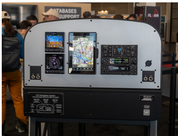
Painel VFR de demonstração Garmin: 2x G5, aera 760, GMC 507 (GFC 500), GNC 215 e GTX 345. Foto: Matti Blume – Wikimedia Commons, licença CC BY-SA 4.0.
