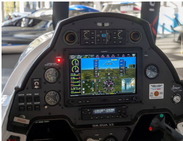
Foto real: cabine com G3X Touch 10,6", GMC (piloto automático) e rádio COM Garmin, TL-Ultralight OK-ZUA 23. Foto: Matti Blume – Wikimedia Commons, licença CC BY-SA 4.0.
