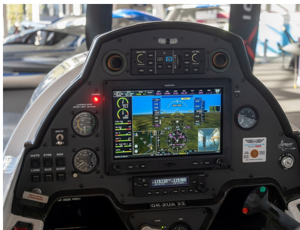
Aeronave leve com Garmin G3X Touch 10,6" e piloto automático (TL-Ultralight). Foto: Matti Blume – Wikimedia Commons, licença CC BY-SA 4.0.
