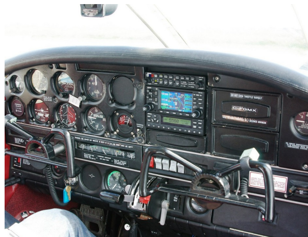
Piper PA-28 com retrofit de rádio-navegador Garmin (série GNS). Foto: Telets – Wikimedia Commons, licença CC BY-SA 3.0.
