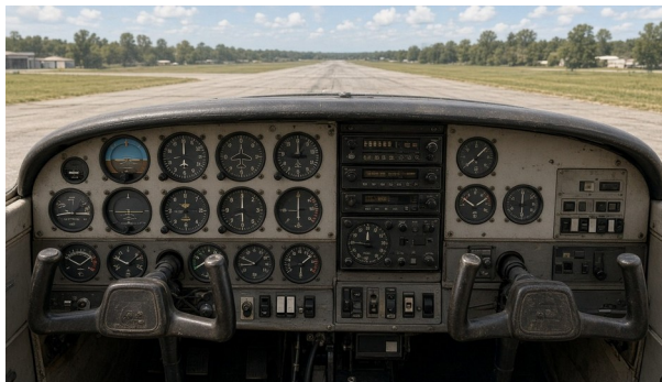
Ilustração / simulação — não é foto real. Piper PA-28/Tupi ANTES: instrumentos a vácuo e rádios antigos.
