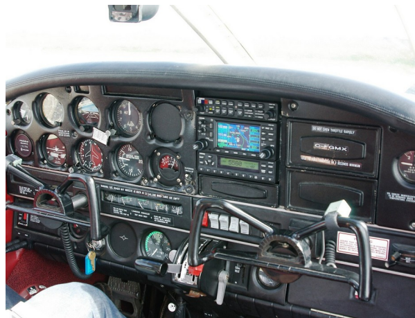
Foto real: Piper PA-28 Cherokee com rádio-navegador Garmin da série GNS instalado em retrofit (antecessor do GTN Xi) e instrumentos analógicos. Foto: Telets – Wikimedia Commons, licença CC BY-SA 3.0.
