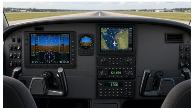
Ilustração / simulação — não é foto real. PA-28 DEPOIS: PFD 10,6", reserva eletrônica, GTN e piloto automático (conceito).
