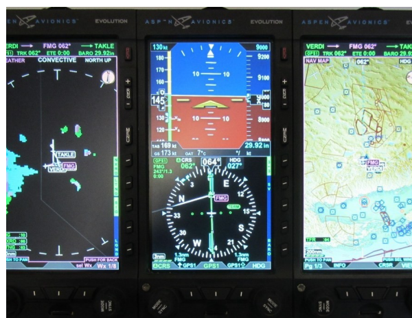
Foto real: telas Aspen Evolution (PFD/MFD que entram nos furos existentes). Foto: FlugKerl2 – Wikimedia Commons, licença CC BY-SA 3.0.
